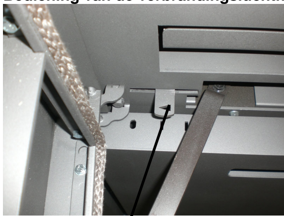
Regelhendel voor de verbrandingsluchttoevoer
