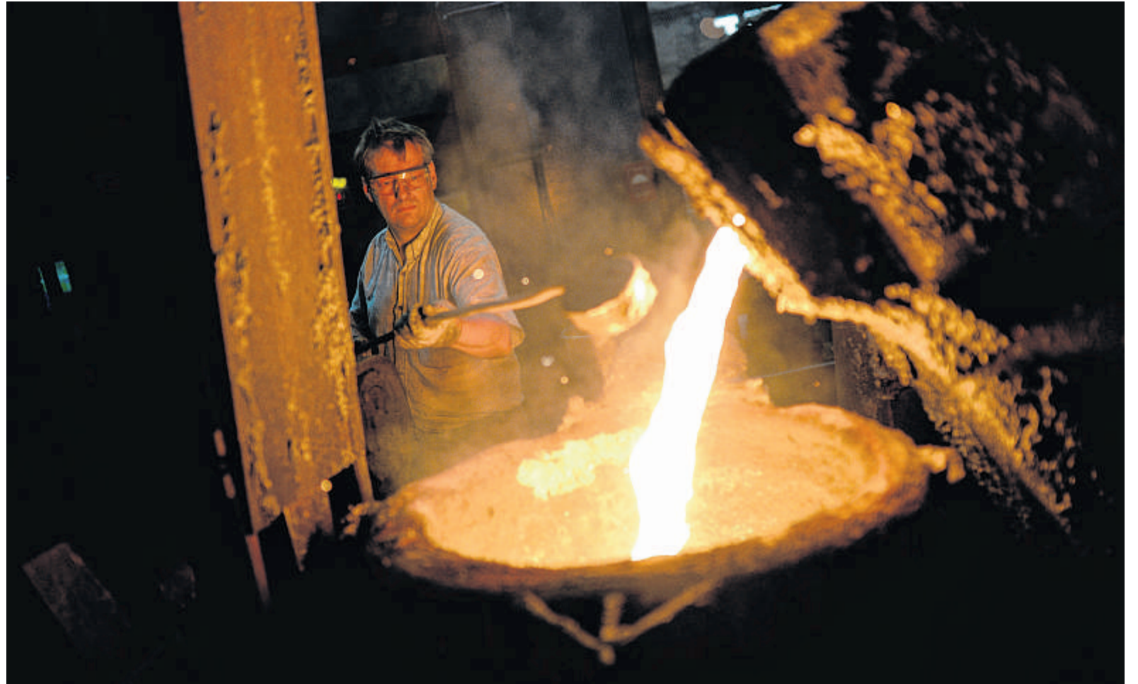
Heißes Eisen: Geschmolzenes Gusseisen wird in Formen gefüllt. Die Firma Olsberg gehört unverkennbar zu den energieintensiven Betrieben.
